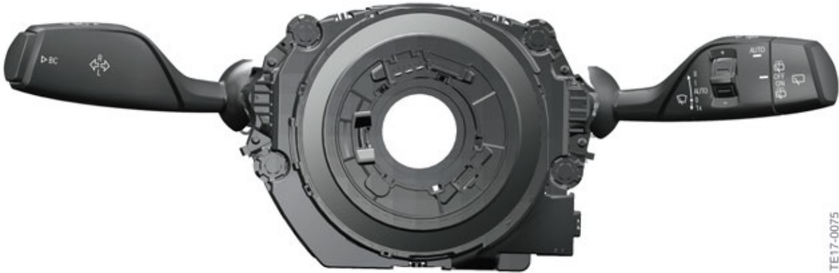
Steering column switch cluster (SZL)
