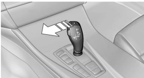
Wählhebel aus Wählhebelposition D nach links drücken.
