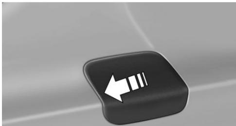
2. Tankverschluss gegen den Uhrzeigersinn drehen.
