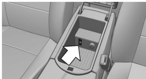
In der Mittelarmlehne kann über den AUX-In-Anschluss ein externes Audiogerät, z. B. ein MP3-Spieler, angeschlossen werden.
