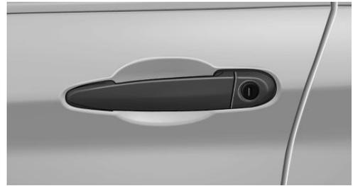
Fahrtür über das Türschloss mit dem integrierten Schlüssel ent- oder verriegeln. Die anderen Türen müssen von innen ent- oder verriegelt werden.
