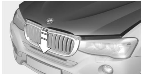
Motorhaube aus ca. 40 cm Höhe fallen lassen und nachdrücken, um die Motorhaube wieder vollständig zu verriegeln.
