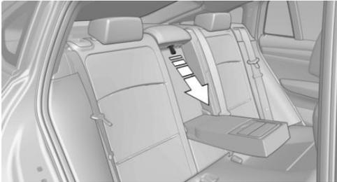
Die Mittelarmlehne herunterklappen und an der Schlaufe ziehen.
