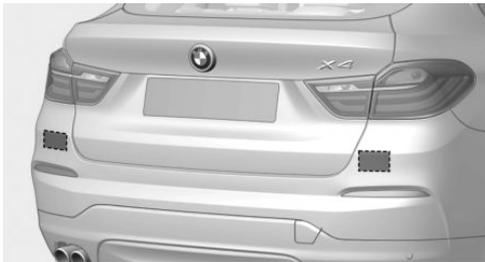
Die Radarsensoren befinden sich unter dem hinteren Stoßfänger.
