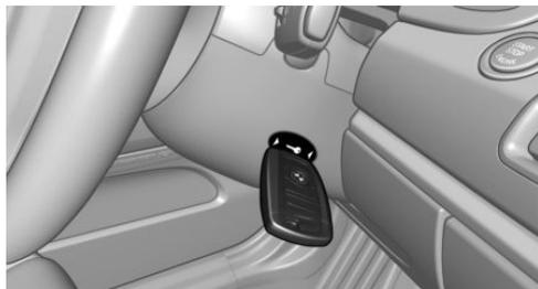
Automatic-Getriebe: Bei entsprechender Check-Control-Meldung die Fernbedienung, wie abgebildet, an die Markierung an der Lenksäule halten und innerhalb von 10 Sekunden bei getretener Bremse den Start-/Stopp-Knopf drücken.
