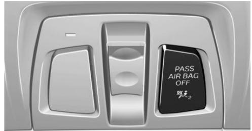
Die Kontrollleuchte der Beifahrerairbags zeigt den Funktionszustand der Beifahrerairbags an.
