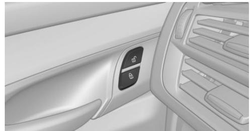
Über die Tasten für Zentralverriegelung.
