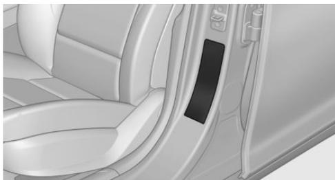
Die Druckangaben für freigegebene Reifengrößen befinden sich an der Türsäule der Fahrertür.
