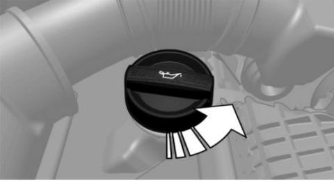
Die Menge von 1 Liter Öl erst nachfüllen, wenn die Meldung in der Instrumentenkombination angezeigt wird.
