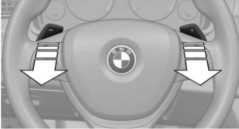
Die Schaltwippen am Lenkrad ermöglichen einen schnellen Wechsel der Gänge, ohne dabei die Hand vom Lenkrad zu nehmen.
