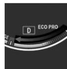
Im Drehzahlmesser zeigt ein langer Pfeil bis zum Nullpunkt der Balkenanzeige an, dass ein vorausliegender Streckenabschnitt erkannt wurde.
